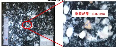
同軸落射、175倍でAl2O3-SiO2系耐火物粉体を撮影し、中央の粒子の粒子径を測長した
